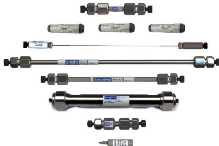
Tipikus HPLC oszlop 15 cm x 4,6 mm x 5 \mu m
