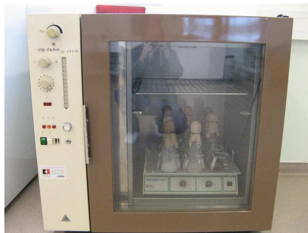
12. ábra: Hűtő, fűtő termosztát Certomat 12 férőhelyes rázógéppel.
