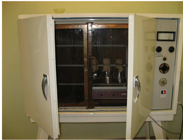
11. ábra: Rézköpenyes általános fűtő bakterológiai termosztát analóg kijelzővel, rázógéppel
