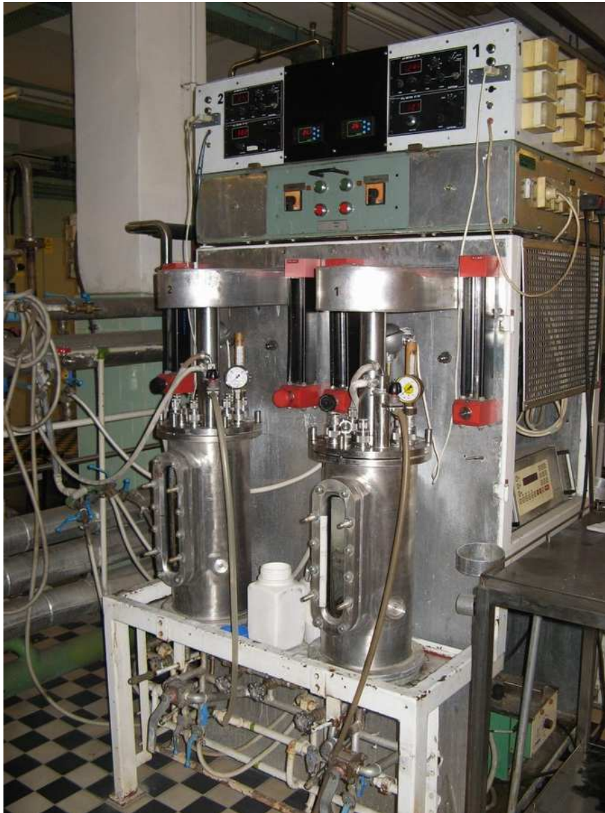
13. ábra: Rozsdamentes acél helyben sterilizhető 10 liter hasznos térfogatú párosával elrendezett félüzem.
