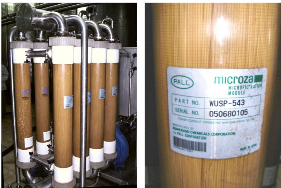
4.3.6.3.7. ábra: Nagyméretű üregesszál modulok sejtek kiszűrésére
