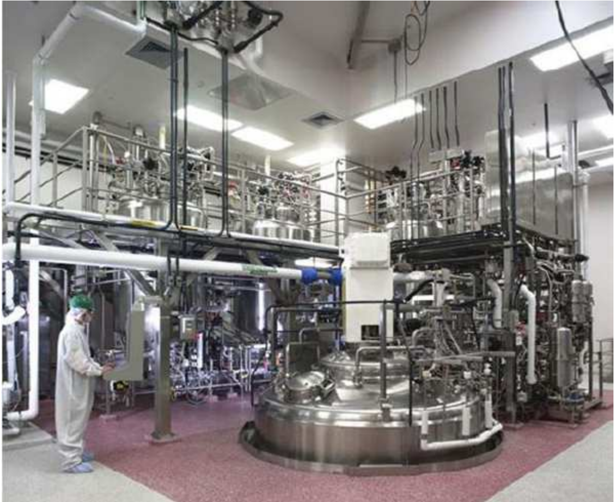
302. ábra 15 m 3 -es termelő bioreaktor, nagy része a padozat szintje alatt
