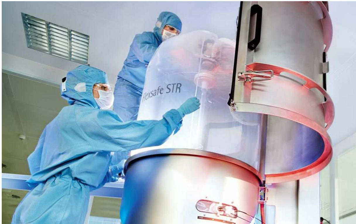
318. ábra 200 literes keverős egyszer használatos bioreaktor beállítása
