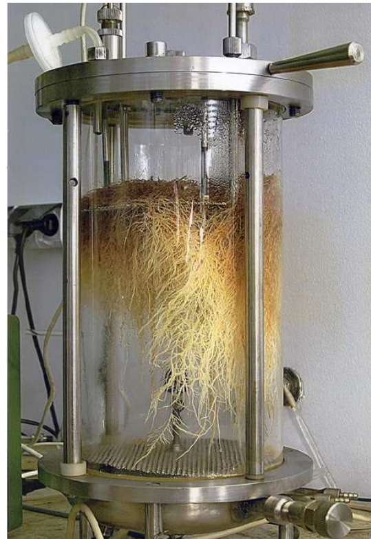
206. ábra Hajszálgyökér tenyészet laboratóriumi fermentorban
